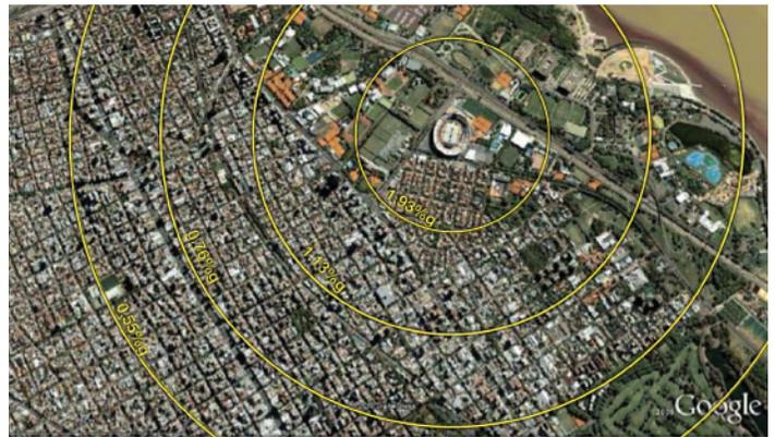
Fig. 2. Valor medio cuadrático de las aceleraciones horizontales en la azotea de edificios con frecuencia natural coincidente con el salto de los espectadores (2Hz) a 500, 1000, 1500 y 2000 m del estadio de River Plate
